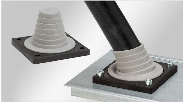
Le KEL-JUMBO flex est un système passe-câbles pour des câbles non confectionnés ayant un diamètre de 27 à 68 mm. Le KEL-JUMBO flex peut de préférence être utilisé pour introduire des câbles de puissance dans l'armoire électrique. Du fait du modèle pyramidal extrêmement souple, l'introduction et le positionnement du câble sont très simplifiés par rapport aux presse-étoupes traditionnels.
